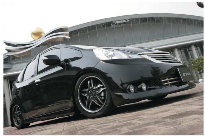
[SIZE] FRONT: 16inch×6.5JJ INSET50mm TIRE: 185/55-16 REAR: 16inch×6.5JJ INSET50mm TIRE: 185/55-16 COLOR: ガンブラックカットクリア (GKP) \*\*フェンダー加工
