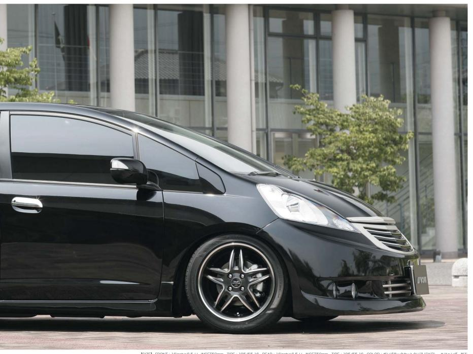
[SIZE] FRONT: 16inch×6.5JJ INSET50mm TIRE: 185/55-16 REAR: 16inch×6.5JJ INSET50mm TIRE: 185/55-16 COLOR: ガンプラックカットクリア (GKP) \*\*フェンダー加工
