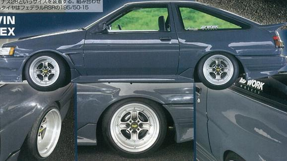
リヤもFRP製ブリスターフェンダーでワイド化されている。装着するホイール＆タイヤサイズはアントと同じだ。足回りにはTRDのナンバーにレート8kg/mmのスプリングを組む。ブレーキは純正エリバーとビッグローターで強化する。 LSDはTRDの2ウェイ
