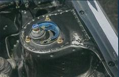
フロントの足回りにはエンドレスのZEAL改に10kg/mmのスイフトスプリングが組まれている。フレーキはヴィルウッド製4ポット。なお、エクワイア40にはビッグキャリパー装着車用にTディスクのラインナップがある。
