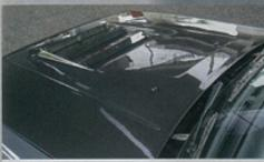
ボンネットのみカーボン柄を活かした無漆仕上げ。3段になったダクトは先端の1段目以降がカーボン板でふさがれていて、細かな配慮がうかがえる
