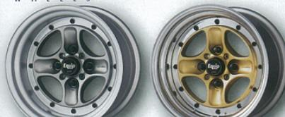
15インチ専用設計となっているエクイップ40。リムのサイズランナップはPCD114.3の場合、エクイップ01、03と同様の5.5から13インチまでと非常に幅広く、セミオーダーカラー・リムアレンジメント(各色のアルマット加工など)にも対応可能だ。標準のディスクカラーは上部ブルッシュルバーと、スプリントゴールドの2色。クラシカルで新しい、70年代車から90年代車までマッチングが気になる最新のエクイップシリーズの逸品だ
