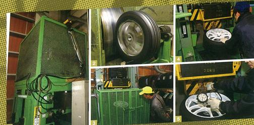
この加工工程を経てホイールは完成となるが、ワークでは品質のクオーリティを保つための検査基準も、これを行われている。その検査基準も、国土交通省が定める「鋼管金型ディスクホイールの安全技術基準」を通り越えるワーク独自の「ワーク標準」が実行されている。例えば、13度の角度で重りをボイールのリムに落とし、破裂やエア漏れがないかどうかを検査する衝撃試験では、基準値よりもはるかに高い位置から重りを落とした結果、ボイールをついた状態で連続走行するような条件を再現した。ホイールの耐久性や発熱など、を検査する回転曲げ疲労試験では、最も高い回転数で試験が行われている。「正面、製造者の側としては、「ワーク基準、はかなり高い基準です」と苦労している千原工場長だが、「この厳
