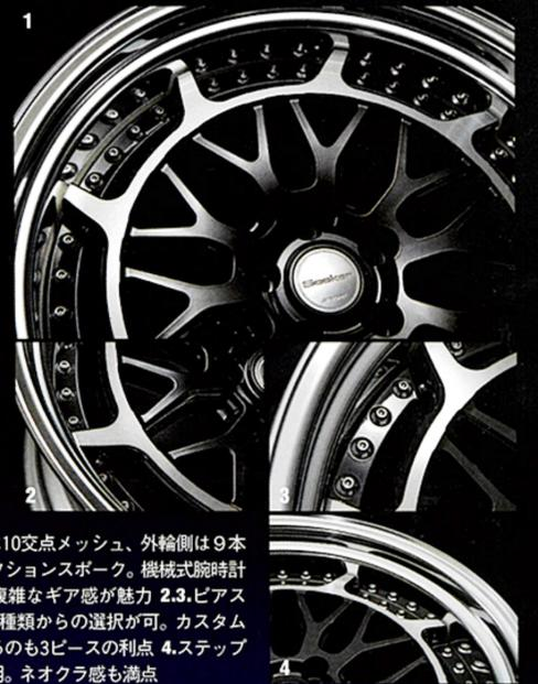
1.内輪側は10交点メッシュ、外輪側は9本のディレクションスポーク。機械式腕時計のような複雑なギア感が魅力 2.3.ピアスだけでも4種類からの選択が可。カスタムを楽しめるのも3ピースの利点 4.ステップリムを採用。ネオクラ感も満点
